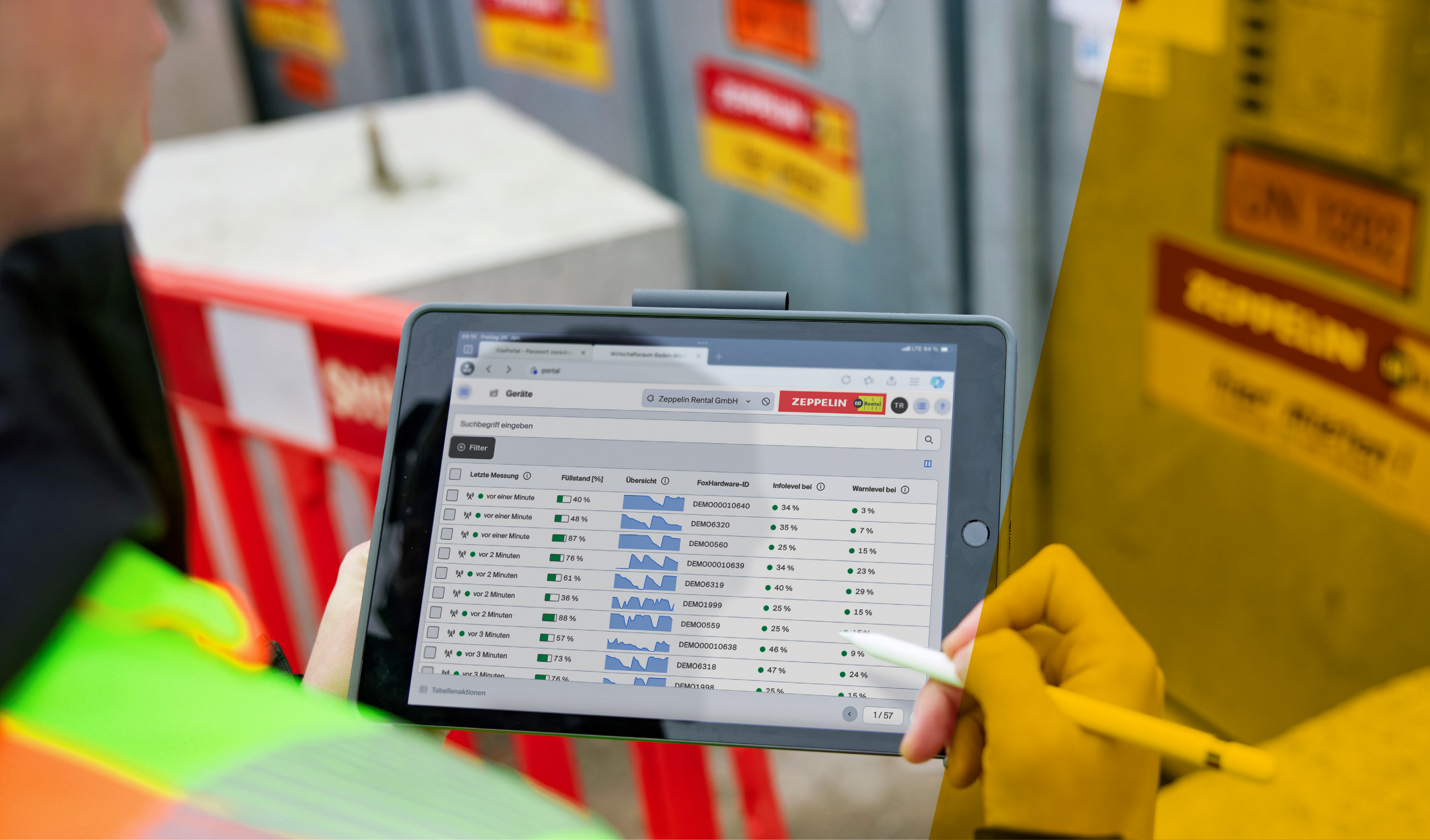
Der Kunde legt im FoxPortal die Werte für ein zweistufiges Warnsystem fest. Wird der festgelegte Füllstand erreicht, erhält er eine automatische Benachrichtigung per E-Mail
